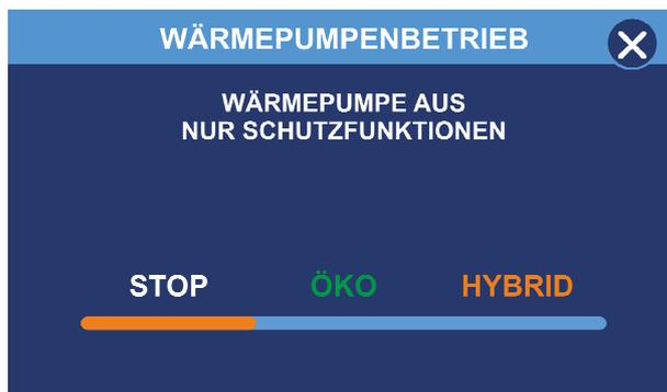
**STOPP- Betrieb** -Wärmepumpe ausgeschaltet.
