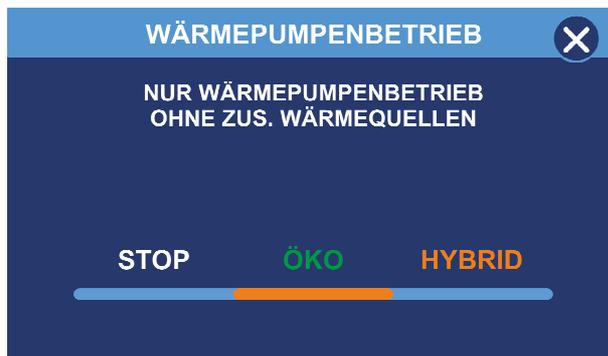
**ÖKO-Betrieb** - Die Warmwasser- und Pufferspeicher-Solltemperaturen können nur bis zur Maximaltemperatur der Wärmepumpe eingestellt werden. Ein externer Elektroheizstab wird nur eingeschaltet, wenn die Brauchwasserzusatzladung aktiv ist oder eine Pumpenstörung vorliegt.
